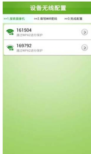
选择你所需要修改的设备 ID，点击。我们以 161504 为例，此时客户端在连接 161504 的网络，连接成功后，直接跳转到“填写 WiFi 密码”界面。如下图所示。此时要求填写的是手机客户端连接的 WiFi 的密码，正确填写后，摇头机将自动连接到手机的 WiFi 网络。填写完成后点击“下一步”，直接提示配置成功，已成功连接网络。
