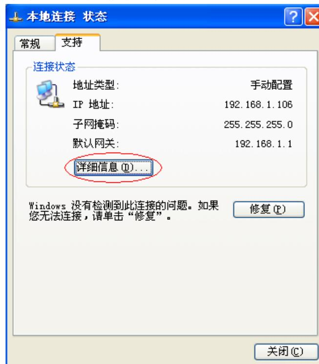
4) 出现“网络连接详细信息”页面，记录页面中的“IP 地址”、“子网掩码”、“默认网关”、“首选 DNS 服务器地址”、“备用 DNS 服务器地址”信息，见下图：
