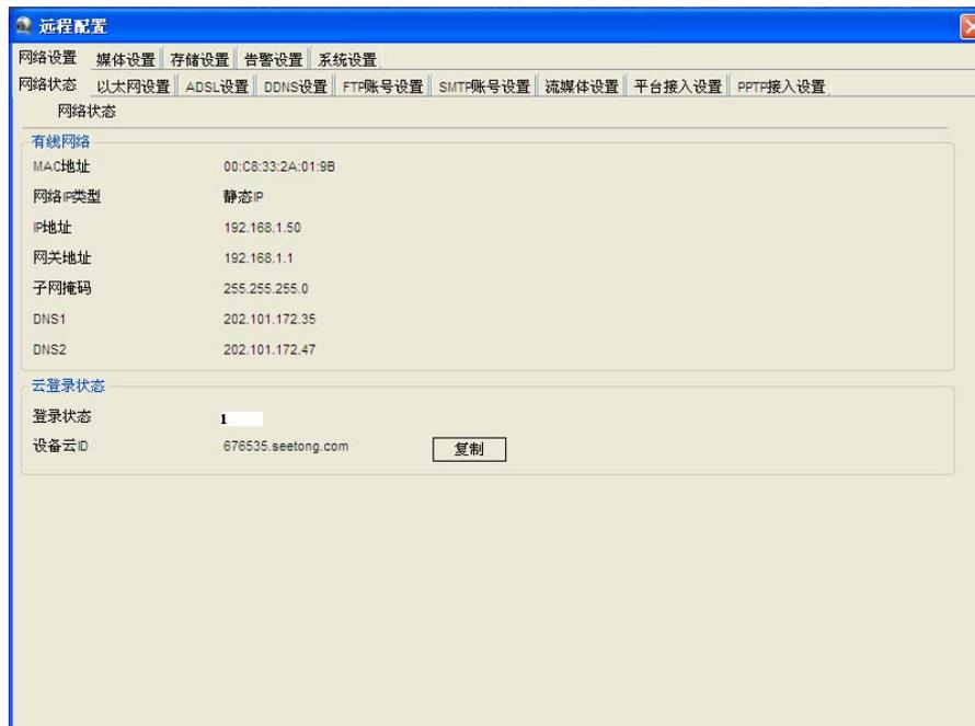
到此，这台 NPC 摄像机的设置全部完成，请记住“设备云 ID”对应的 6 位 ID 号码。请用上述同样的方法完成其他摄像机的设置，**注意云登录状态必须是“1”**
