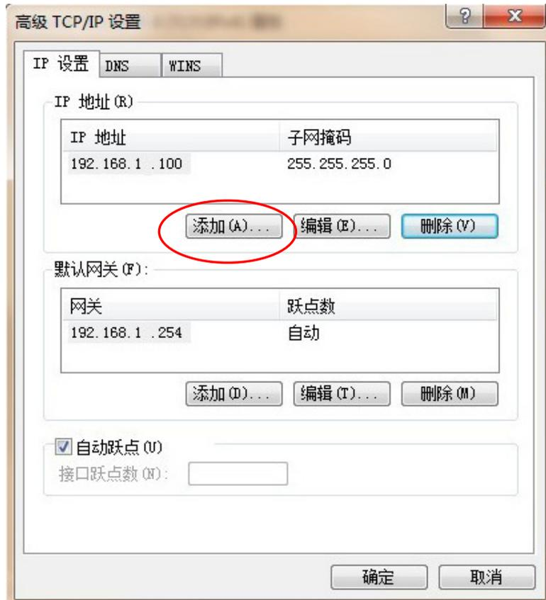
3) 在跳出的对话框中输入与摄像机匹配的 IP 段，然后点击“添加”，见下图：
