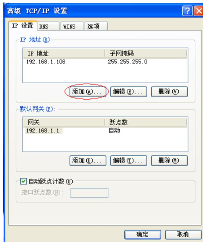
3) 在弹出的对话框中输入与摄像机出厂设置的 IP 同一网段的任一 IP 地址（例如 192.0.0.106），然后点击“添加”，见下图：
