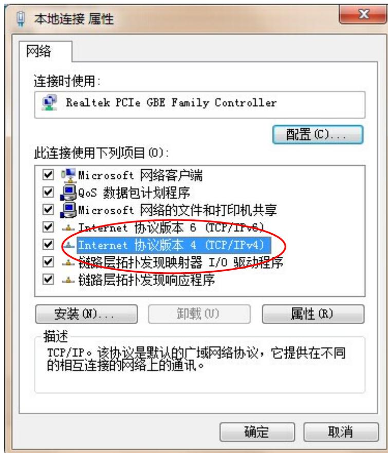
7) 在“internet 协议版本 4 (TCP/IP)”对话框中点击选中“使用下面的 IP 地址”，将记录下来的“IP 地址”、“子网掩码”、“默认网关”、“首选 DNS 服务器地址”、“备用 DNS 服务器地址”信息填入空框中，见下图：
