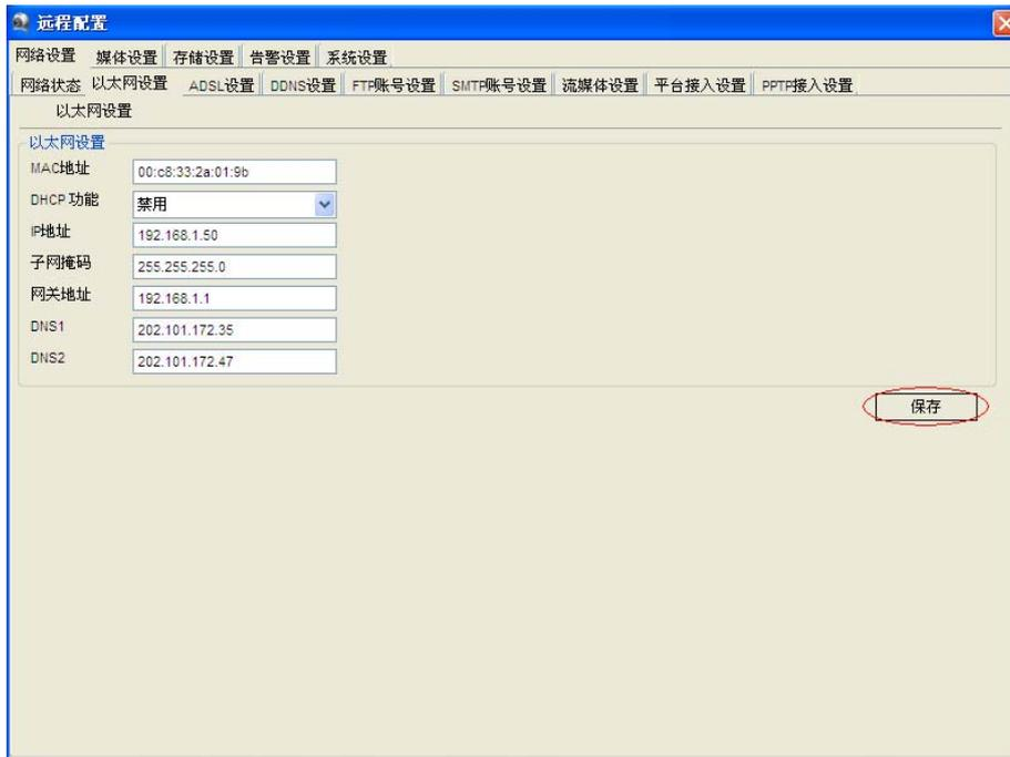
6、关闭浏览器。重新打开浏览器，在网址栏里输入上一步改好的 IP: 192.168.1.50 重复上面的 1、2、3 步，进入“以太网设置”页面，注意下面的“云登录状态”栏，出现“云登录状态”和“设备云 ID”信息，如下图。
