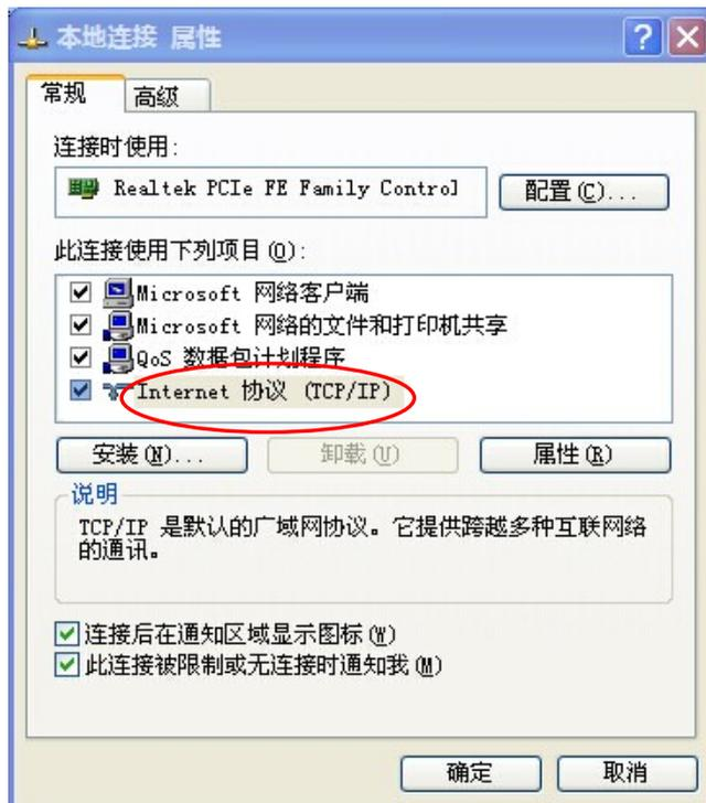
7) 在“internet 协议 (TCP/IP)”页面选中“使用下面的 IP 地址”，将记录下来的“IP 地址”、“子网掩码”、“默认网关”、“首选 DNS 服务器地址”、“备用 DNS 服务器地址”信息填入空框中，见下图：
