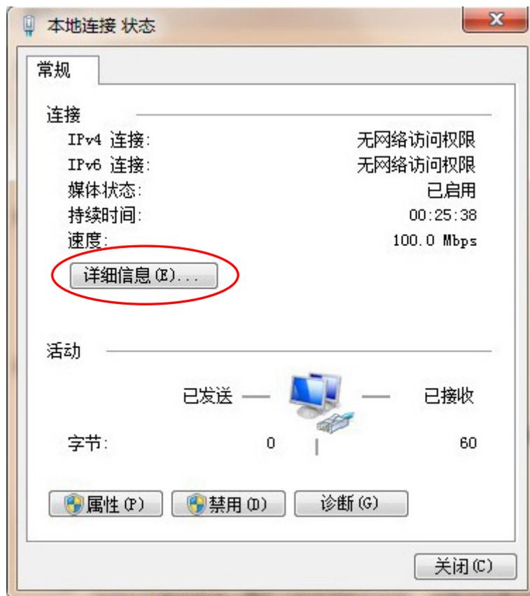
4) 点击页面中“详细信息”按钮，出现“网络连接详细信息”对话框，记录对话框中的“IP 地址”、“子网掩码”、“默认网关”、“首选 DNS 服务器地址”、“备用 DNS 服务器地址”信息，见下图：
